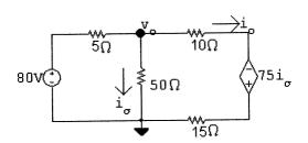
$$\frac{v_o - 80}{5} + \frac{v_o}{50} + \frac{v_o + 75i_\sigma}{25} = 0; \quad i_\sigma = \frac{v_o}{50}$$
