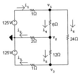
$$\frac{v_1 - 125}{1} + \frac{v_1 - v_2}{6} + \frac{v_1 - v_3}{24} = 0$$
