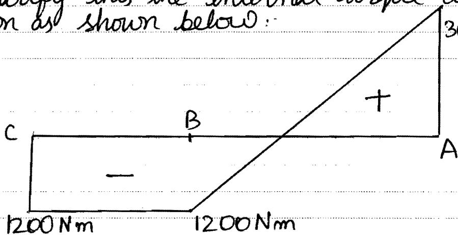
$$T_{max} = \frac{T_{max} r_{max}}{J}$$
