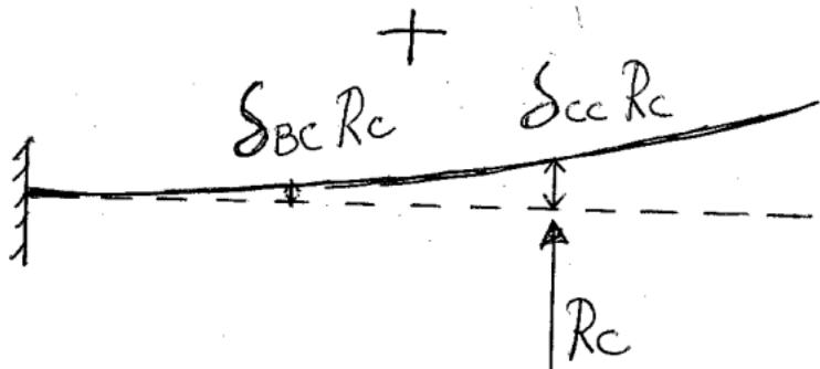
$$\begin{Bmatrix} \Delta_B \\ \Delta_c \end{Bmatrix} + \begin{bmatrix} \delta_{BB} & \delta_{BC} \\ \delta_{CB} & \delta_{CC} \end{bmatrix} \begin{Bmatrix} R_B \\ R_c \end{Bmatrix} = \begin{Bmatrix} -0.1 \\ -0.2 \end{Bmatrix}$$
