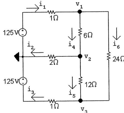
$$\frac{v_1 - 125}{1} + \frac{v_1 - v_2}{6} + \frac{v_1 - v_3}{24} = 0$$
