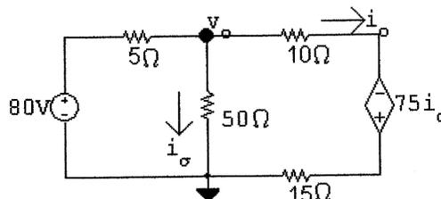
$$\frac{v_o - 80}{5} + \frac{v_o}{50} + \frac{v_o + 75i_\sigma}{25} = 0; \quad i_\sigma = \frac{v_o}{50}$$
