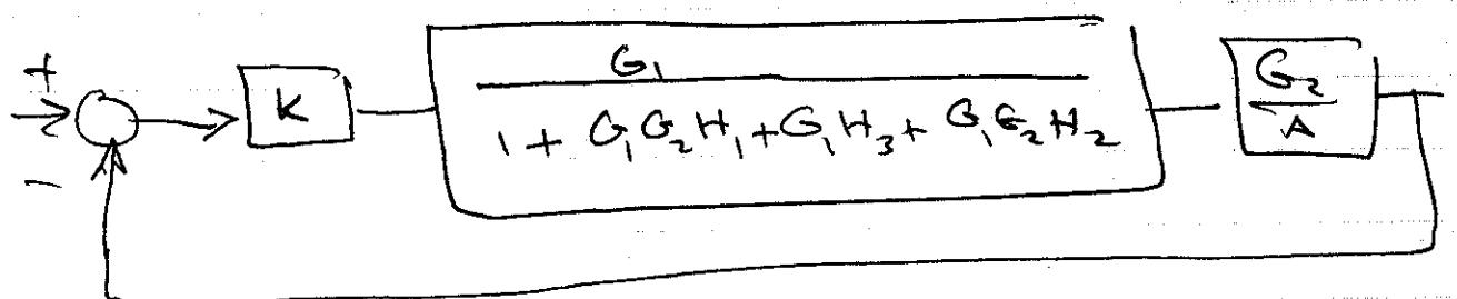
$$T.F = \frac{KG_1G_2/\Delta}{1 + G_1H_3 + G_1G_2(H_1 + H_2) + \frac{KG_1G_2}{\Delta}}$$
