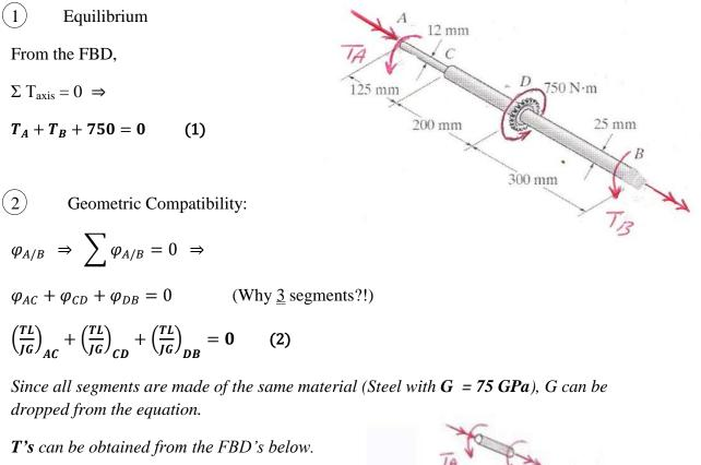
$T_{AC} = -T_A$  $T_{CD} = -T_A$  $T_{DB} = -T_A - 750$
