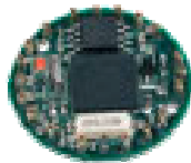
Mica2Dot (Berkeley/Xbow): 8MHz/8bit, 4K/128K
