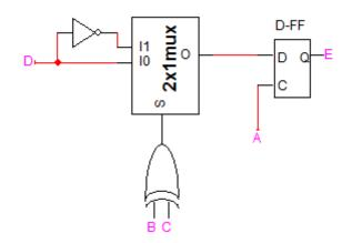
(ii) module FinalQ1\_2 (output reg E, input A, B, C, D);
