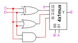
(iv) module FinalQ1\_4 (output E, input A, B, C, D);
