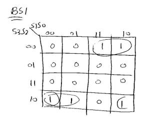
$$BS1 = \overline{S_3}\overline{S_2}S_1 + S_3\overline{S_2}\overline{S_3}$$
