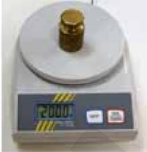
■ الشكل 11-1 : يُختبر الضبط عن طريق قياس قيمة معلومة
