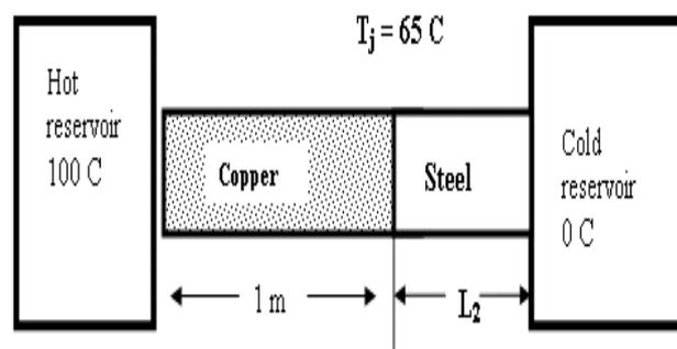
(  $k_{\text{steel}} = 14 \text{ W/m.K}$ ;  $k_{\text{cu}} = 401 \text{ W/m.K}$ ) ( Ans: 0.065 m)
