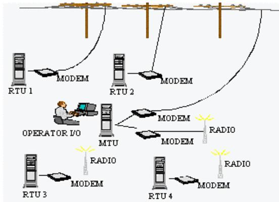
FIGURE I: SCADA SYSTEM MODEL
