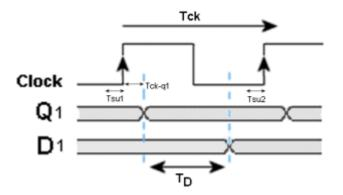
$$\rightarrow T_{ck} \geq T_{ck \rightarrow q1} + T_D + T_{su}$$
