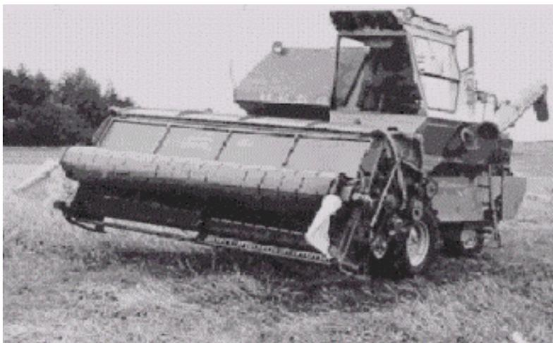
Fig. 2. The stripper header for the combine CK-5 «Niva».
